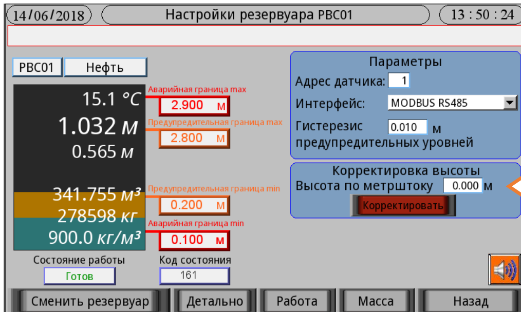
Рисунок 18 – Окно ввода корректировки высоты в панели оператора
