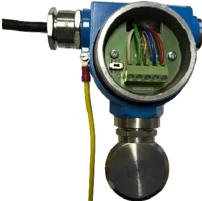
Рисунок 19. Подключение 4 x -проводного небронированного кабеля
