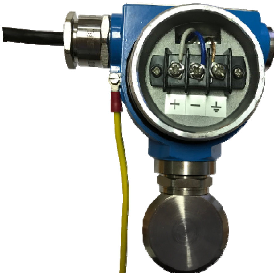
Рисунок 24. Подключение 2 x -проводного небронированного кабеля
