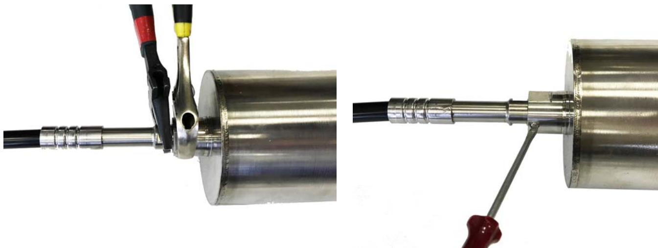
Рисунок 6 – Фиксирование колокола на внешнем корпусе
